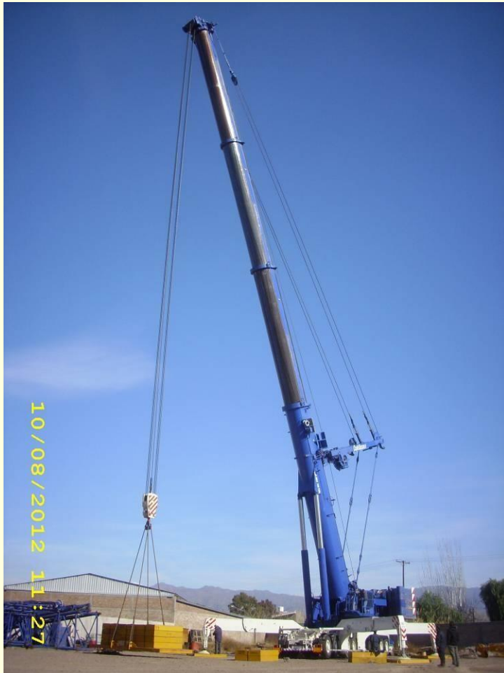
Prueba con carga Grúa Móvil TEREX DEMAG 700 t (CAÑIBANO)
